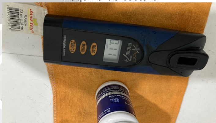
Medidor de cloro
