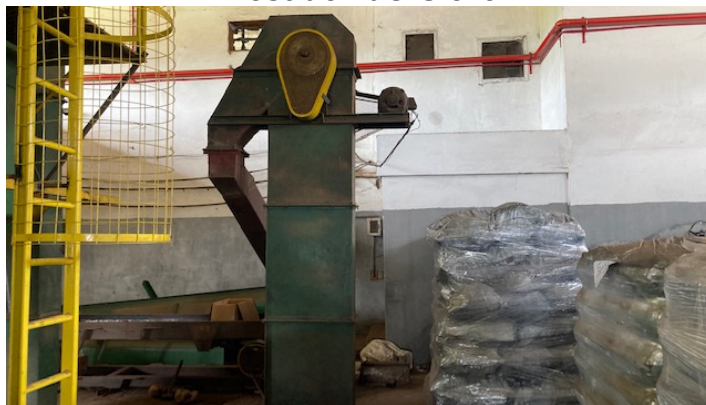
Elevador de caneca aço e carbono de 4 metros
