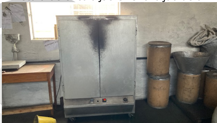
Estufa de esterilização e secagem de 480 litros
