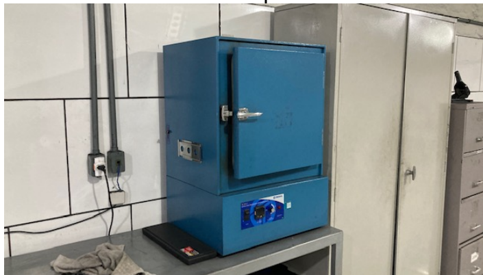
Estufa de circulação e renovação de ar
