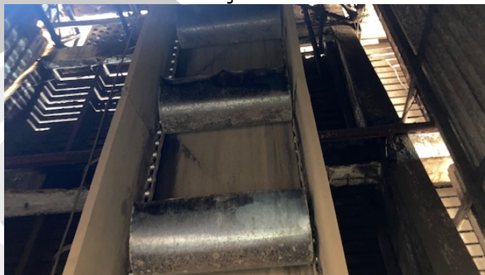
Elevador de caneca aço e carbono de 15 metros
